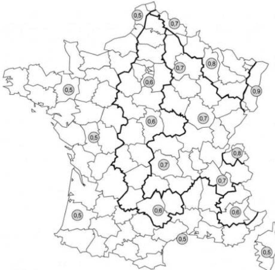
Figure 4-21 : Profondeur hors-gel des fondations
